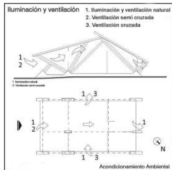
Figura 3.20. Iluminación y Ventilación.
