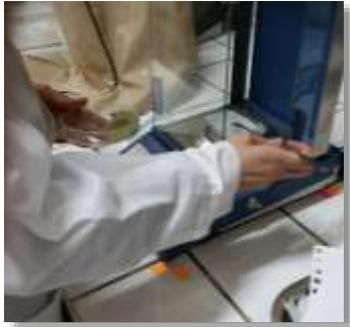
Figura 60. Se pesó 0.5 g de la biomasa seca de *S. dimorphus* por balanza analítica. (fuente: elaboración propia).
