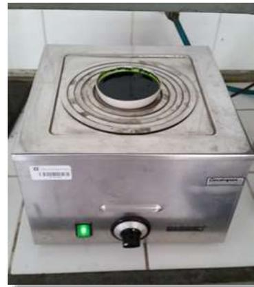
Figura 64. Se evapora la solución de hexano- isopropanol 3:2 (v/v) en baño maría a 95 °C, bajo campana extractora de seguridad. (fuente: elaboración propia).
