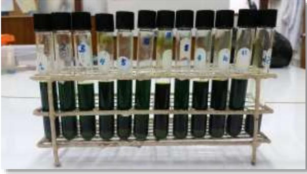
Figura 63. El 12 tubo de ensayo con extracto se dejó reposar por 24 horas a T° de ambiente. (fuente: elaboración propia).
