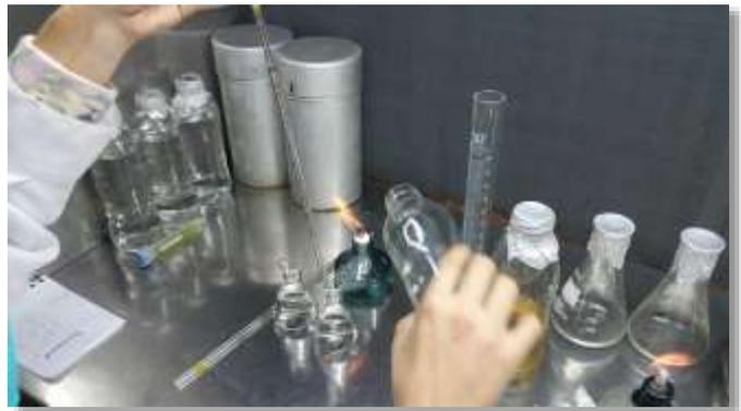
Figura 43. Inoculación de *Scenedesmus dimorphus* en medio de cultivo Guillard F/2 dentro de la cámara flujo laminar. (fuente: elaboración propia).
