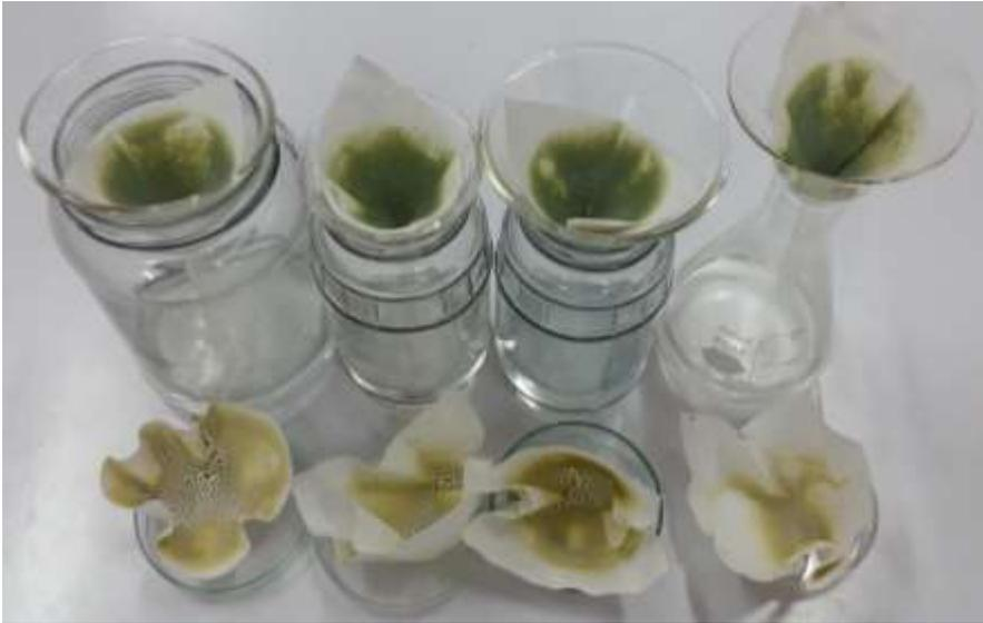
Figura 23. Filtración para la extracción de la biomasa coagulada (fuente: elaboración propia).
