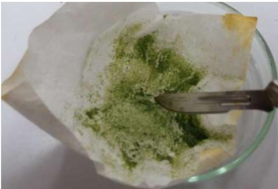
Figura 24. Raspado de la biomasa seca con Bisturí. (fuente: elaboración propia).
