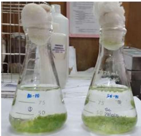
Figura 22. Efecto de coagulación y precipitación en la biomasa por las dos sales de metales polivalentes. (fuente: elaboración propia).
