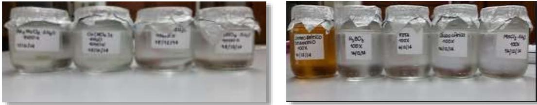
Figura 47. Compuestos químicos que conforman el medio de cultivo BG-11. (fuente: elaboración propia).
