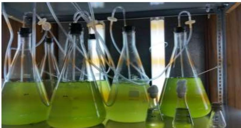
Figura 13. Sistema de cultivo semi-continuo a escala en laboratorio. (fuente: elaboración propia).
