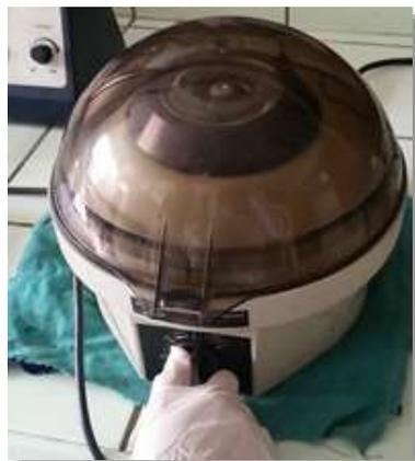
Figura 62. Se colocó en el vórtex cada tubo de ensayo durante un min y luego se puso 6 tubos de ensayo a la centrifuga por 20 min. (fuente: elaboración propia).
