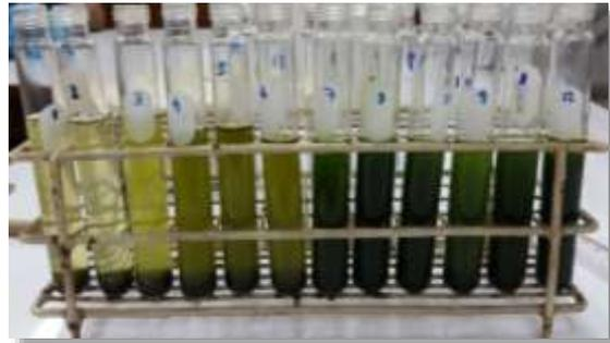
Figura 61. Se agregó 9 mL de hexano- isopropanol 3:2 (v/v) por cada 0.5 g de biomasa. (fuente: elaboración propia).
