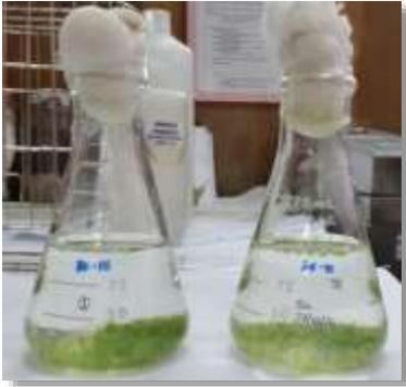
Figura 57. Coagulación de dos muestras de cepas puras de *Scenedesmus dimorphus* en Erlenmeyer de 100 mL. (fuente: elaboración propia).
