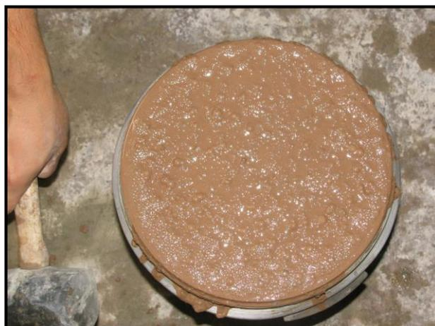
De acuerdo a lo determinado se hizo necesario el uso de un aditivo estabilizador o agente de viscosidad para eliminar la exudación, burbujeo y el sangrado de la mezcla de concreto (hormigón).
