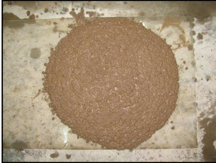
Como se observa, la mezcla de concreto (hormigón) presenta una buena trabajabilidad y fluidez con un Slump de 10" y 50 cm de diámetro, homogeneidad y excelente cohesión.
