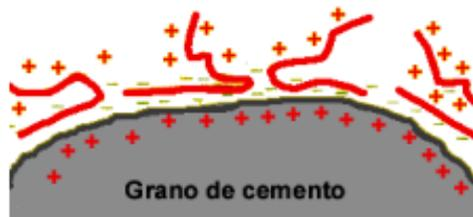
**FIG. 6: Proceso de repulsión electrostática con Superplastificantes Tradicionales**
