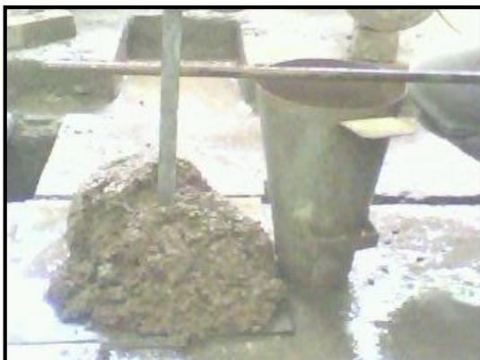
Después de haber realizado el ensayo de cono de Abrams a la mezcla a evaluar, se observa que dicha mezcla que falló por corte por la ausencia de finos en la misma, por tal motivo se aumentó la cantidad de arena hasta la siguiente relación.
