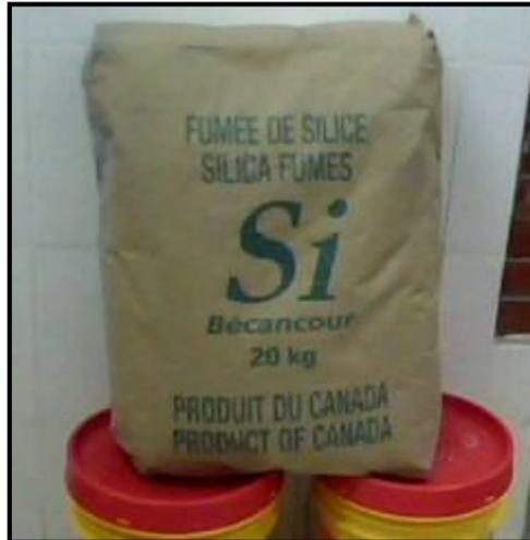
Debido a la presencia de segregación de las mezclas de concreto (hormigón), por falta de finos en nuestra investigación, se hizo necesario el uso de la adición mineral Sika Fume (microsílice) por sus propiedades de cohesión en las mezcla de concreto (hormigón) con bajo contenido de cemento. El rango utilizado de Sika Fume fue de 2% a 5% de acuerdo a cada diseño establecido.
