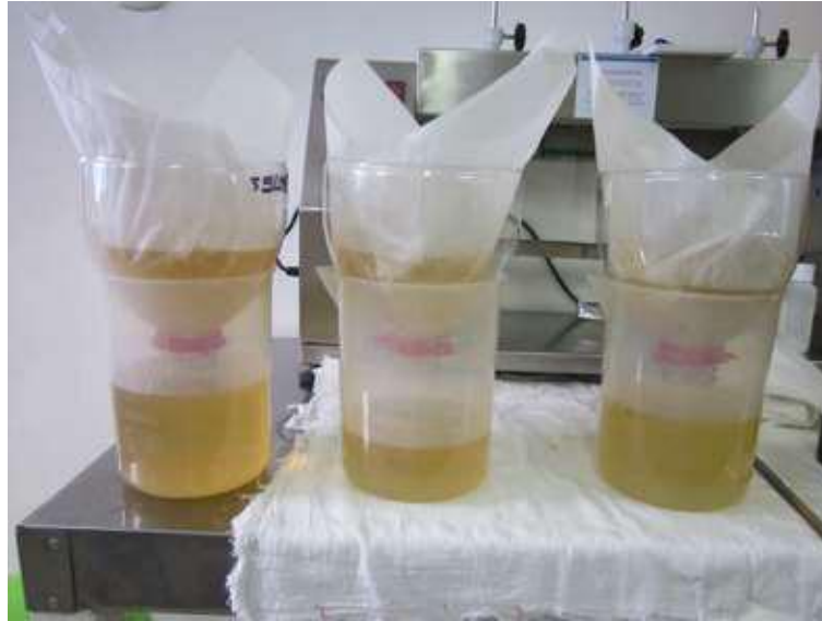
Figura 2. Pre-tratamiento por filtración del efluente no doméstico de industria alimentaria.
