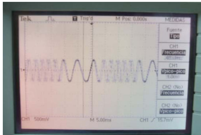
Figura 3.13 Modulación del Sistema V.C.O.
