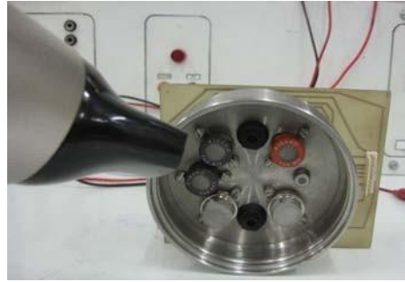
Figura 3.13: Limpieza de la tapa de la cámara de medida.
