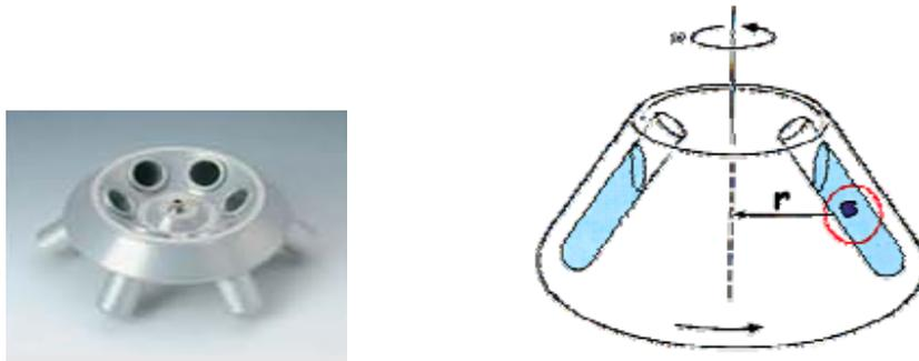
**Figura 7.** – Rotor de ángulo fijo
