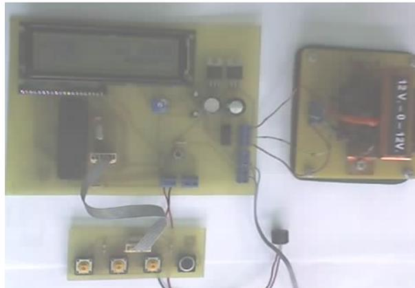
**Figura 24.** –Hardware del panel digital y teclado en segunda versión
