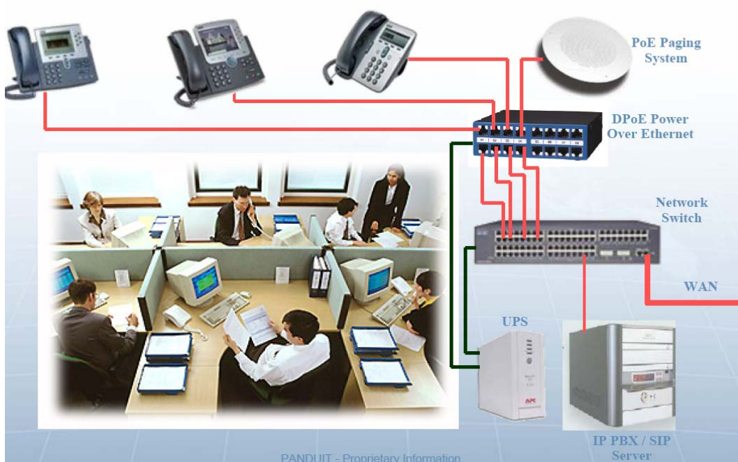
Figura 6 : Red de Telefonía IP utilizando midspan POE
