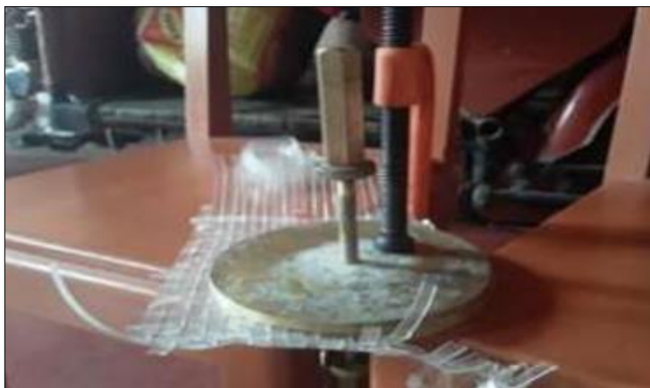
Figura 19 Cortado de geo sintético a dimensiones del molde de CBR
