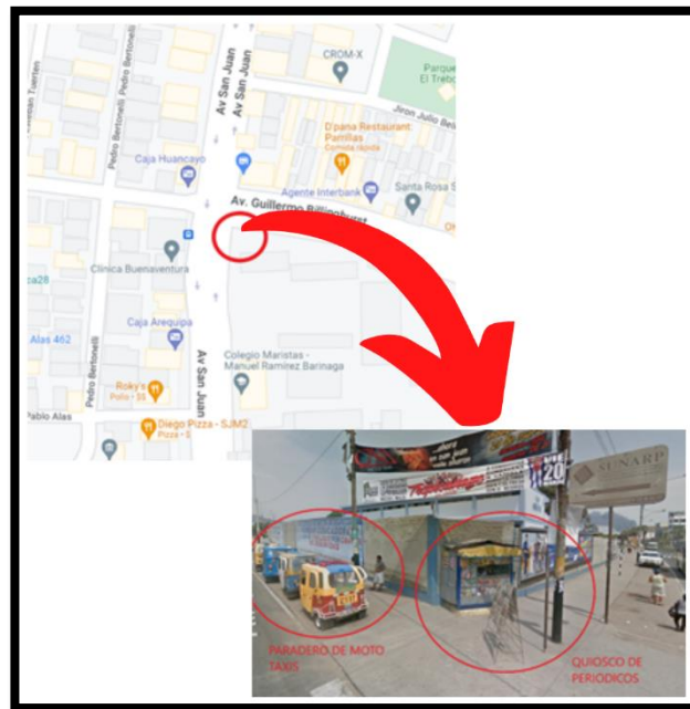
Figura 26: Identificación de restricciones al flujo vehicular Fuente: Elaboración propia
