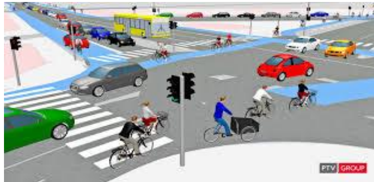
Figura 4: Micro simulación de una intersección en el software VISSIM 9.0 Fuente: PTV Group, 2016
