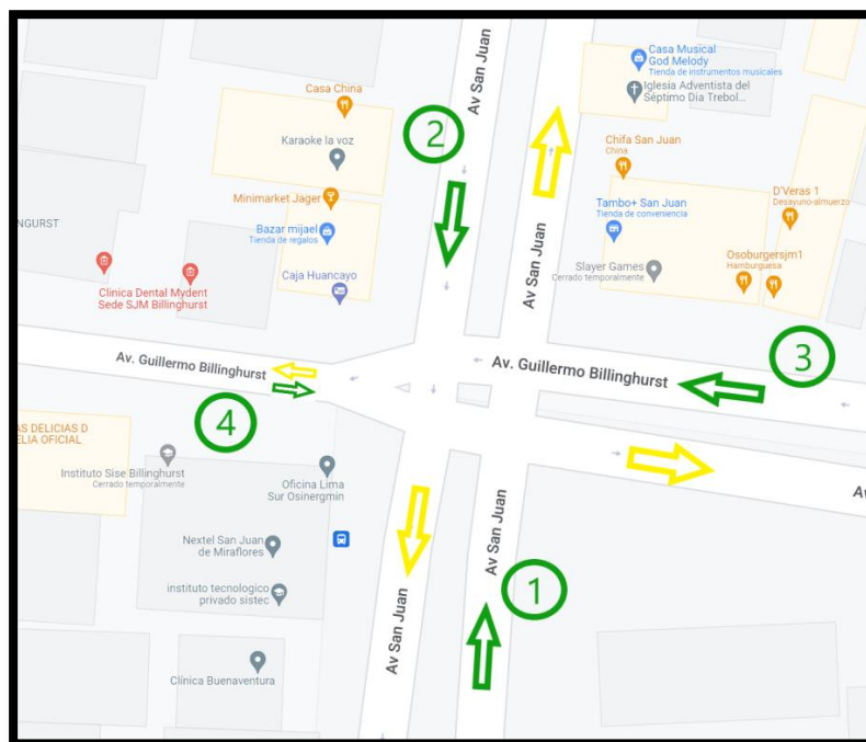
Figura 8: Flujo vehicular de entrada (verde) y salida (amarillo) a la intersección de estudio Fuente: Elaboración propia
