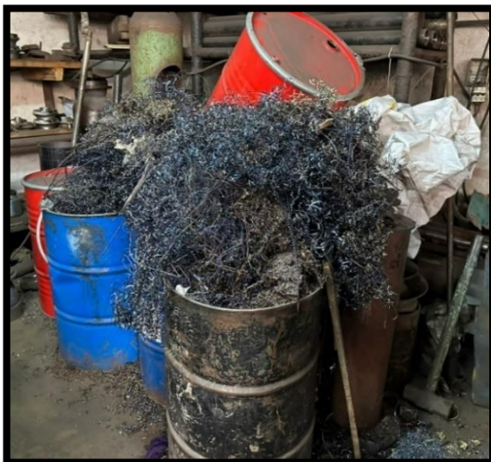
Figura 33 Almacenamiento excesivo de residuos.
