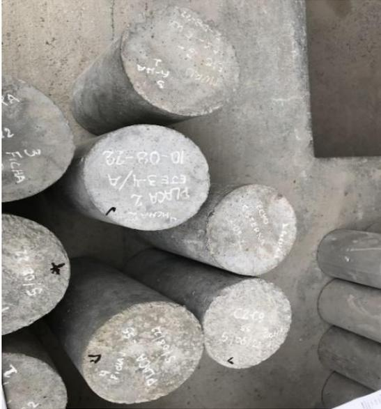
*Nota.* Probetas realizadas durante el vaciado de elementos estructurales
