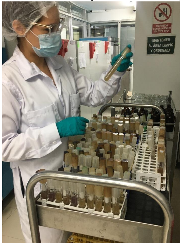
Figura 9. Evaluación de tubos de ensayo con medio “Lauril triptosa” para identificar
