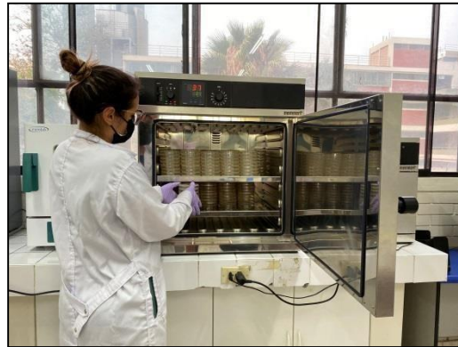
Figura 22. Incubación de las placas a 35°C por 16 a 18 horas
