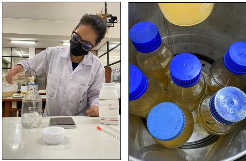
Figura 15. Proceso de preparación y esterilización del Agar Muller Hinton (MH)
