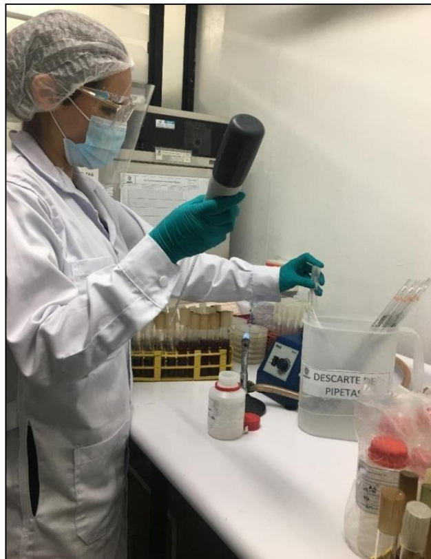
Figura 5. Análisis de una muestra de agua residual desde la dilución inicial de 10ml en tubos de 20 x 150 de doble concentración (2X) hasta la dilución 10^{-5} en tubos de 16 x150 de simple concentración (X)
