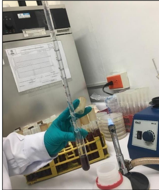
Figura 6. Inoculación de muestra de agua residual a un tubo de ensayo con medio “Lauril triptosa” con púrpura de bromocresol.
