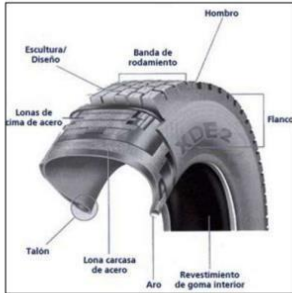
Figura 11: Sección transversal del neumático
