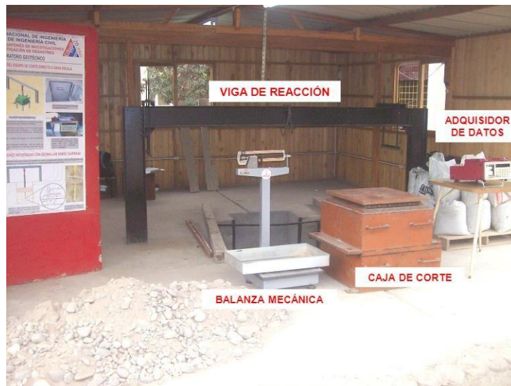
Figura 19. Equipo para ensayo de corte directo a gran escala Fuente: (Basurto, 2010)
