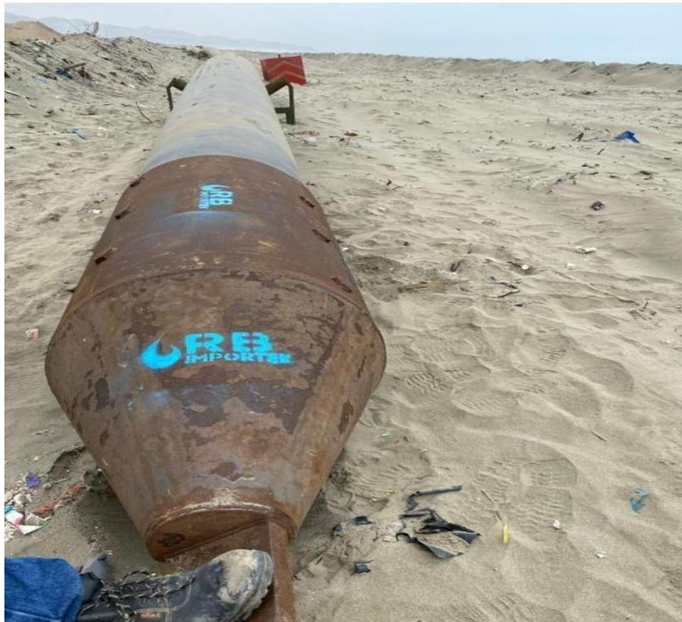
*Figura N° 45: Cabezal de halado Fuente: Propio.*
