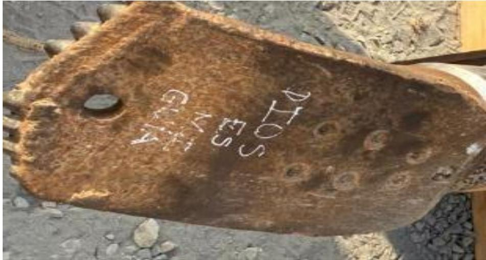
*Figura N° 21: Broca de perforación, tipo pala para terreno arenoso.
