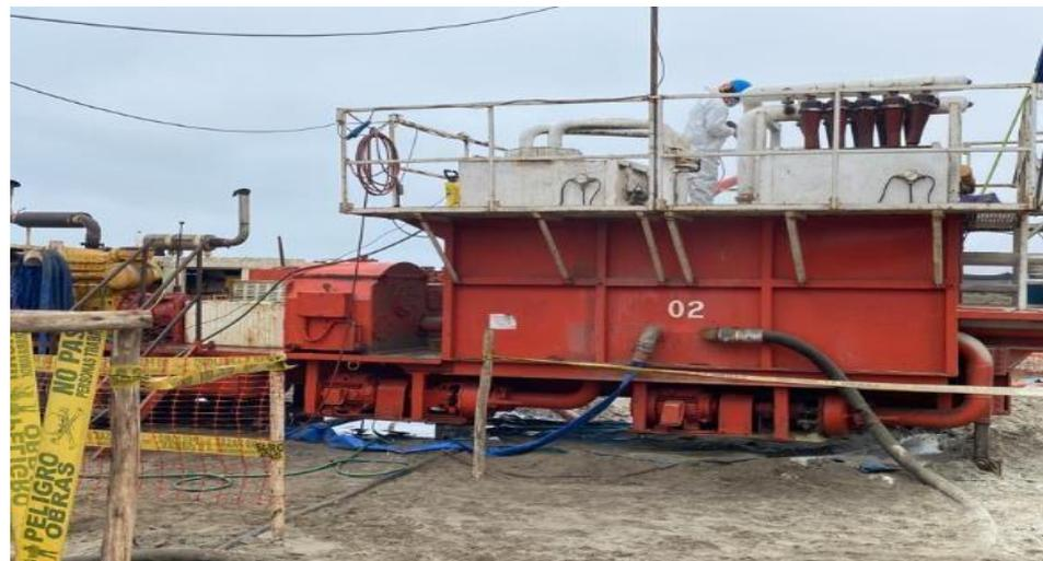
Figura N° 26: Tanque mezclador de lodos. Fuente: Propia.
