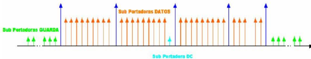
Figura 5.3: Estructura de Subportadoras OFDMA
