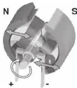
Figura N 15: Motor de corriente continua
