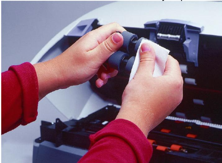
Figura 41 Limpieza e inspección del módulo de alimentación escáner kodak i260
