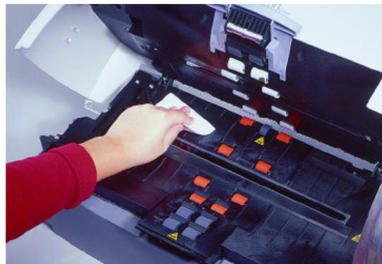
Figura 43 Mantenimiento transporte superior e inferior escáner kodak i260
