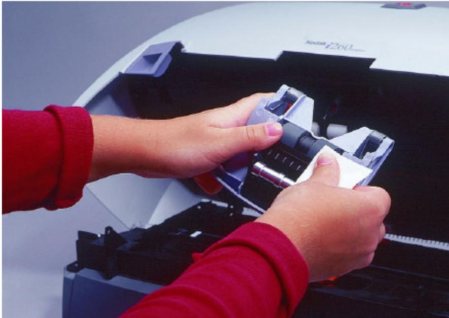
Figura 38 Limpieza del módulo separador del escáner kodak i260
