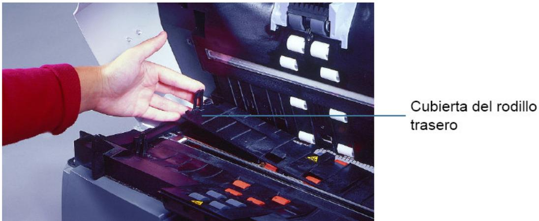
Figura 44 Mantenimiento transporte posterior escáner kodak i260
