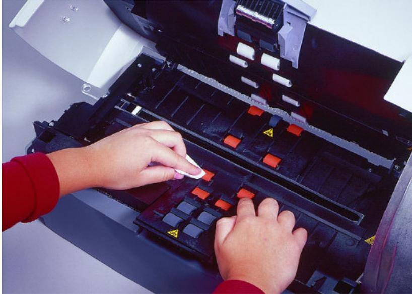
Figura 42 Mantenimiento rodillos de tracción escáner kodak i260
