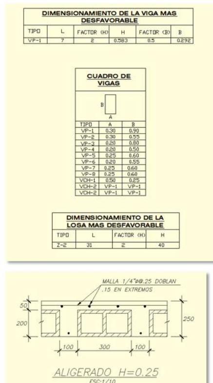
Figura 69. Detalle de aligerado. Fuente Elaboración propia
