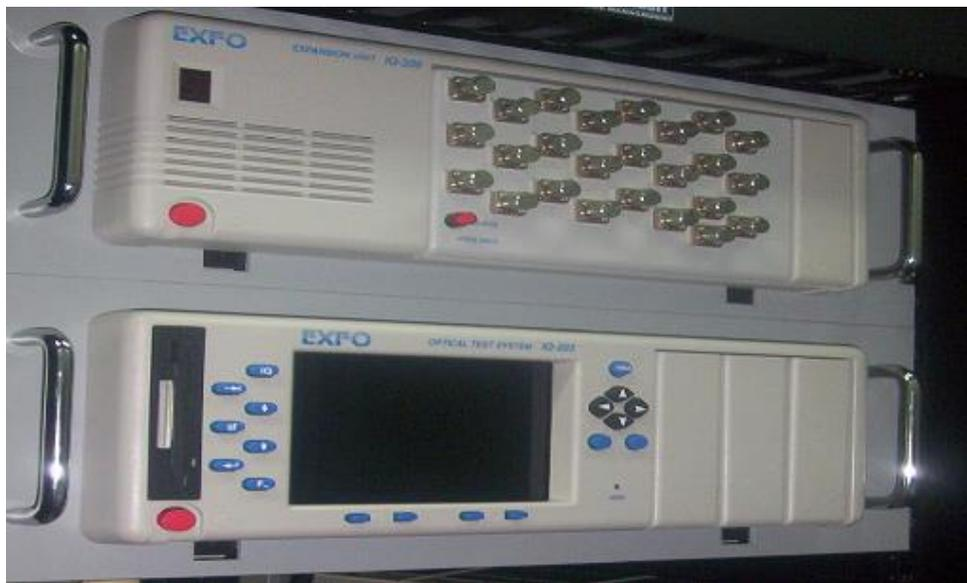
**Fig. 3.4 Foto de una RTU instalada con Conmutador Óptico externo 1x24**
