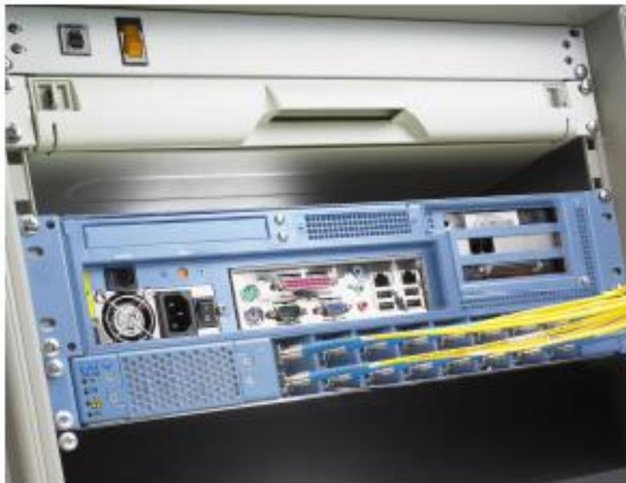
**Fig. 6.7 Foto de una nueva RTU (THC)**
