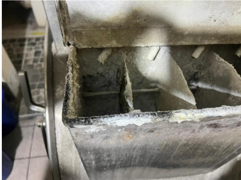
Figura 17: Limpieza de ingreso de detergente
