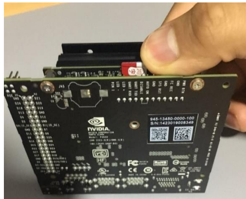
Figura 80. Introducción de micro SD a Jetson Nano
