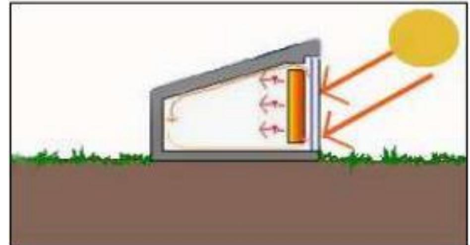
*Figura 37: Muro de Acumulación Ventilado, julio 2017*
