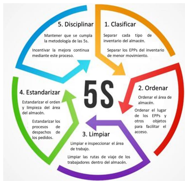
Figura N 31: Pilares 5s propuesta de la unidad minera Fuente: Elaboración propia
