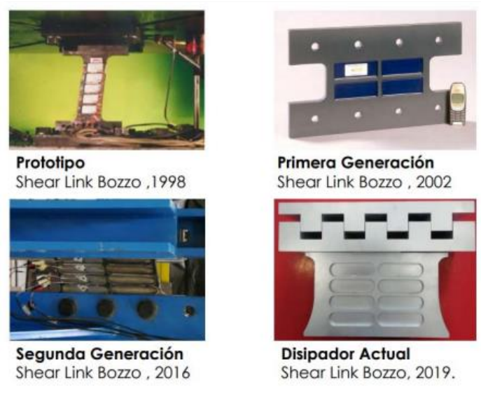
Figura 7: Evolución de los dispositivos “SLB” en el tiempo. Fuente: Una Nueva Generación de Disipadores “SLB SHEAR LINK” Para el Diseño Sismorresistente
