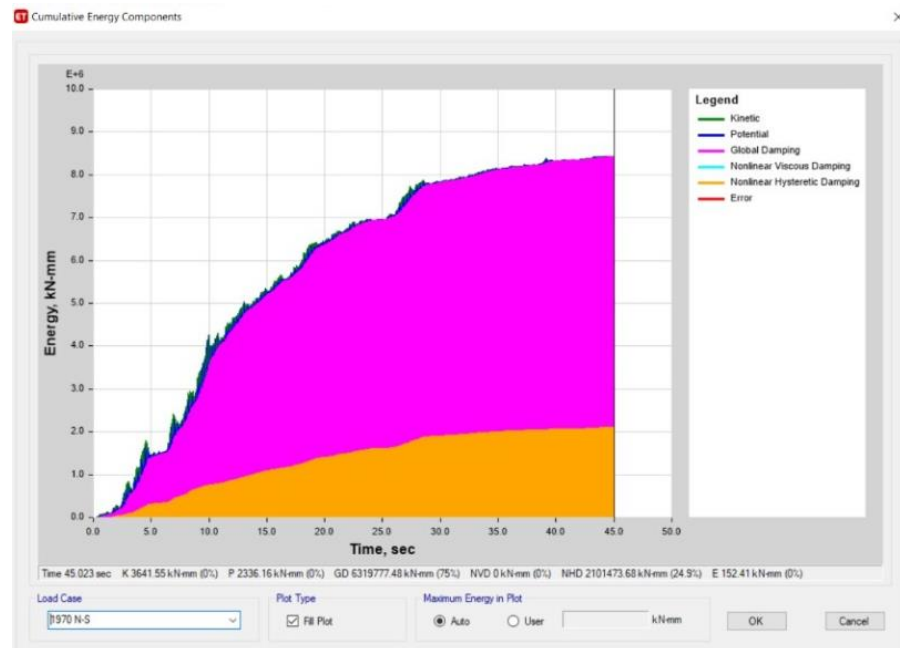
Figura 42: Análisis de Disipación de Energía frente al sismo de 1970 N-S. Fuente: Elaboración Propia
