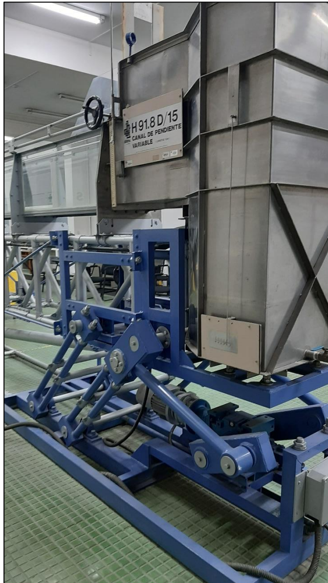
Figura N 3: Motor reductor para variar la pendiente Fuente: Laboratorio de hidráulica de la Universidad Ricardo Palma
