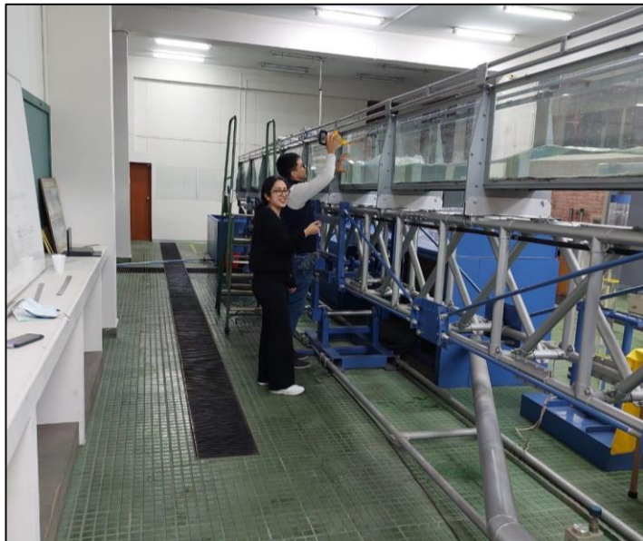
Figura N 14: Medición de periodo de la ola en el canal de pendiente variable Fuente: Laboratorio de hidráulica de la Universidad Ricardo Palma
