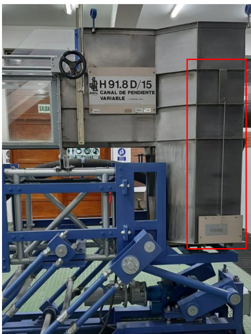
Figura N 10: Péndulo del Canal de pendiente variable Fuente: Laboratorio de hidráulica de la Universidad Ricardo Palma
