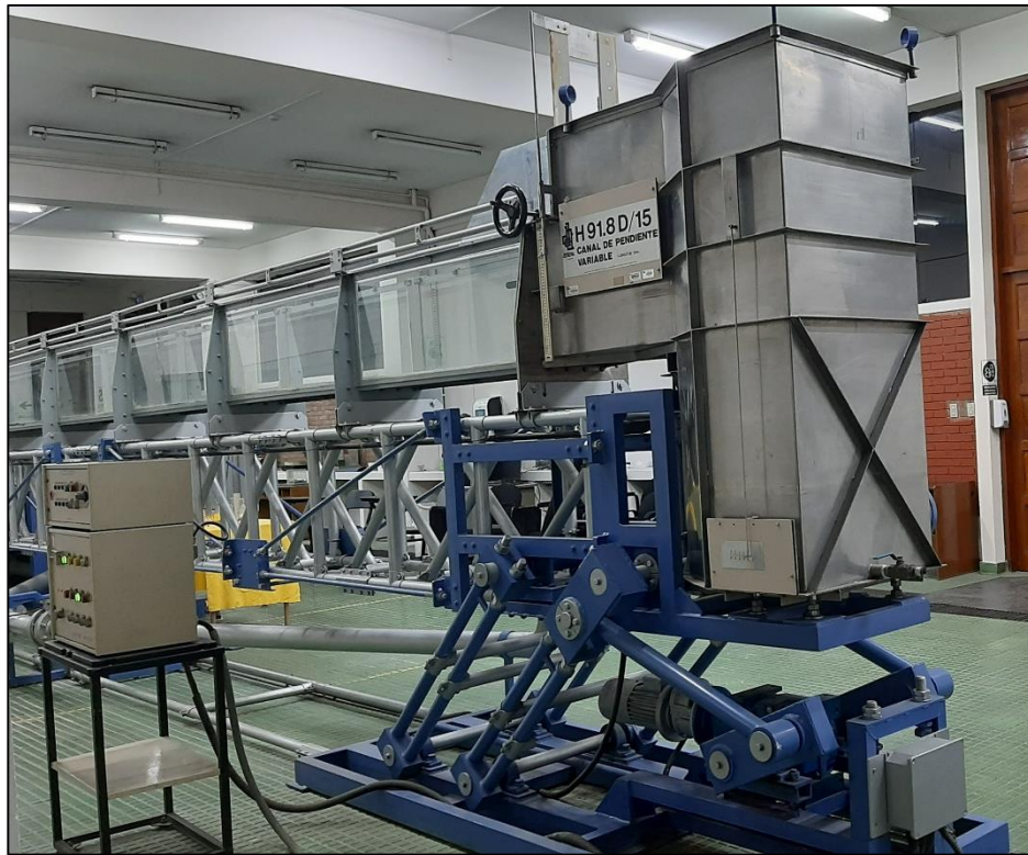
Figura N 2: Canal de pendiente variable del Laboratorio de hidráulica de la Universidad Ricardo Palma (vista 1)
