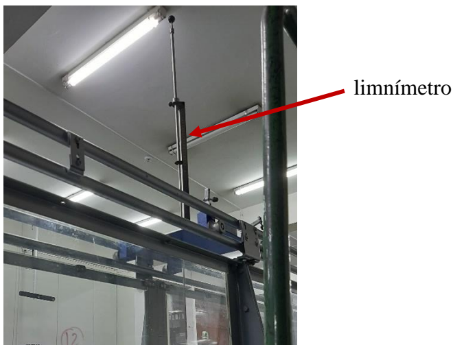
Figura N 12: Limnómetro del canal de pendiente variable Fuente: Laboratorio de hidráulica de la Universidad Ricardo Palma
