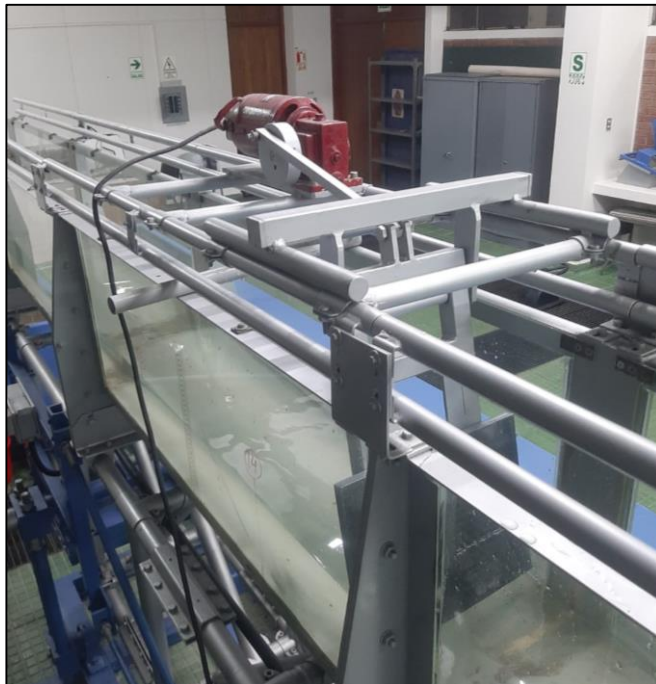
Figura N 5: Generador de ondas Fuente: Laboratorio de hidráulica de la Universidad Ricardo Palma
