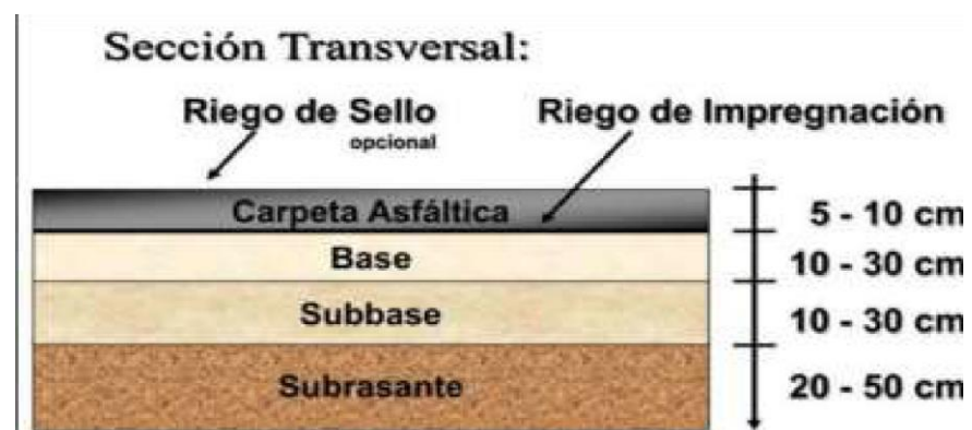
Figura N° 4. Sección de la estructura del pavimento
