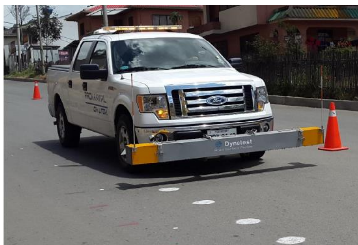
Figura 97. Perfilómetro láser midiendo en mismo sitio que el ensayo volumétrico.
