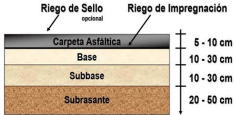
Figura 2. Estructura de pavimento flexible.
