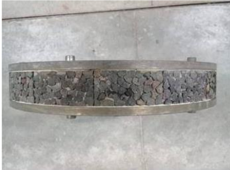
Figura 37. Vista de las probetas en rueda de ensaye.
