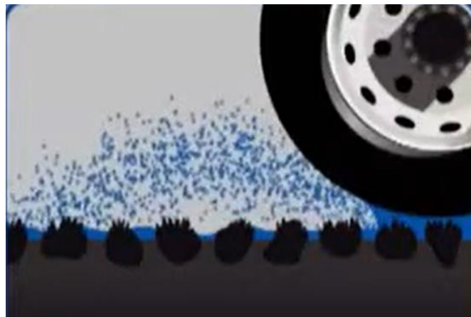
Figura 49. Hidroplaneo en pavimentos.
