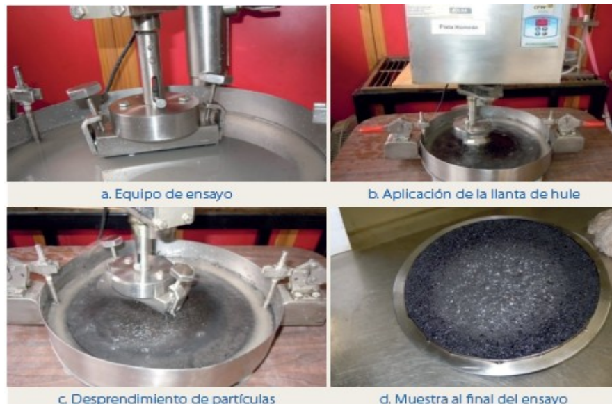
Figura 24: Ensayo de Abrasión Vía Húmeda
