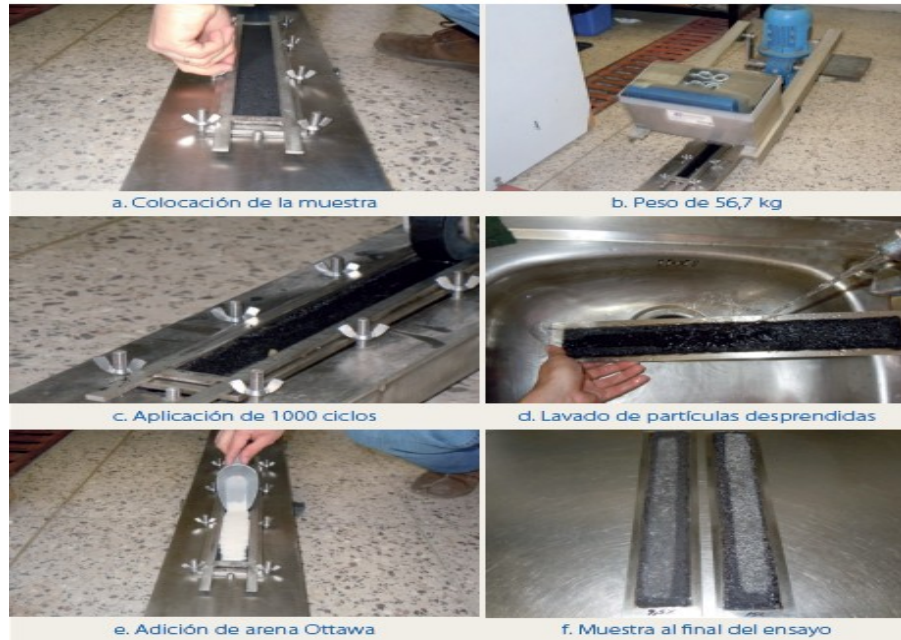
Figura 25: Ensayo de Rueda Cargada
