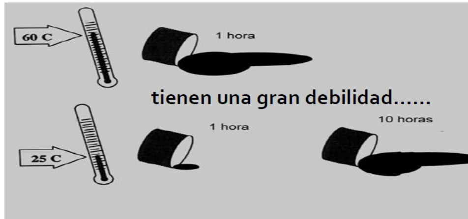
Figura 3: Susceptibilidad térmica del asfalto Fuente: Huamán, Néstor (2019)
