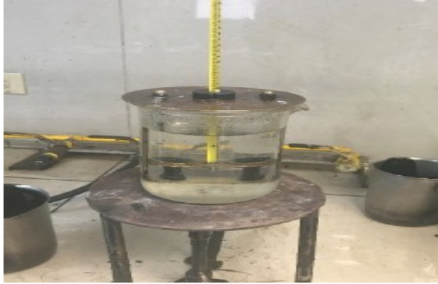
Figura 36: Ensayo de punto de ablandamiento Fuente: Estrada Escalante (2017)
