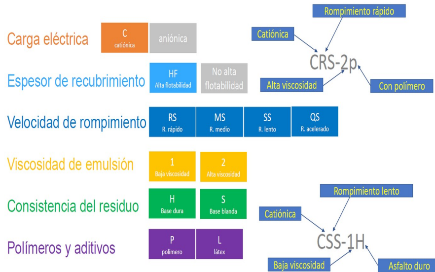
Figura 9: Nomenclatura de una emulsión asfáltica
