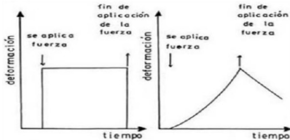
Figura 4: Comportamiento de los cuerpos frente a la aplicación de una carga Fuente: Zegarra (2020)
