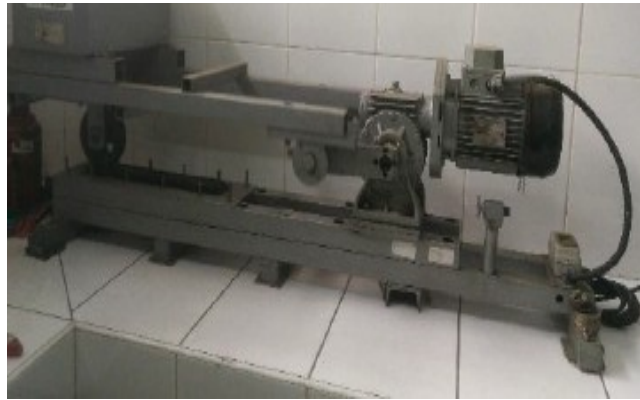
Figura 43: Máquina de ensayo de rueda cargada Fuente: Quispe Espinoza (2021)
