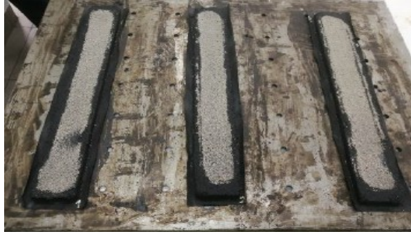
Figura 44: Arena adherida a las muestras de Slurry Seal Fuente: Quispe Espinoza (2021)
