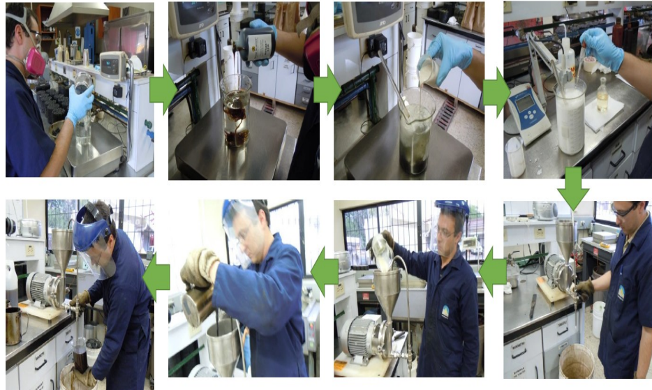
Figura 16: Elaboración de una emulsión asfáltica en laboratorio Fuente: Laboratorio Nacional de Materiales y Modelos Estructurales (2022)
