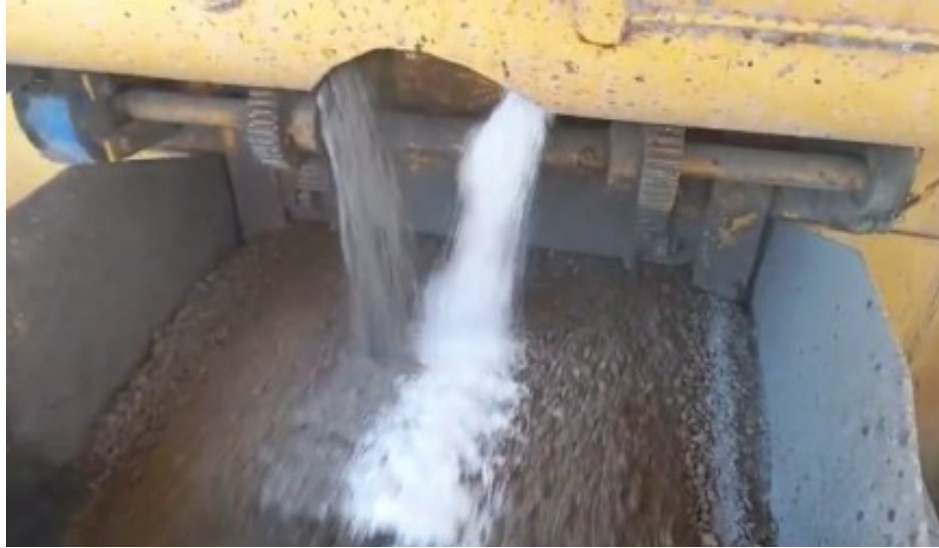
Figura 22: Inyección de fibra de vidrio Fuente: Huamán Murillo (2021)
