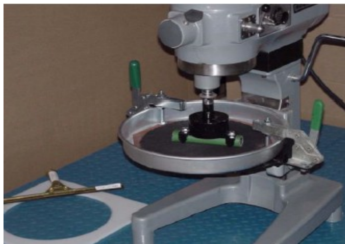
Figura 42: Máquina de ensayo de abrasión en húmedo Fuente: Quispe Espinoza (2021)
