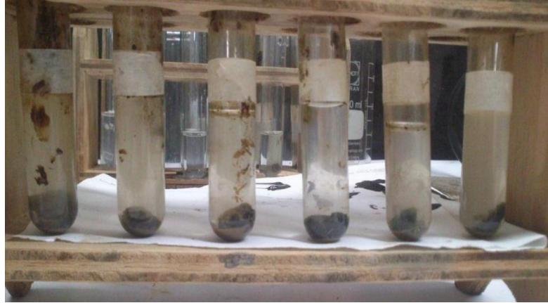
Figura 33: Ensayo de Riedel - Weber Fuente: Gómez y Solano (2016)
