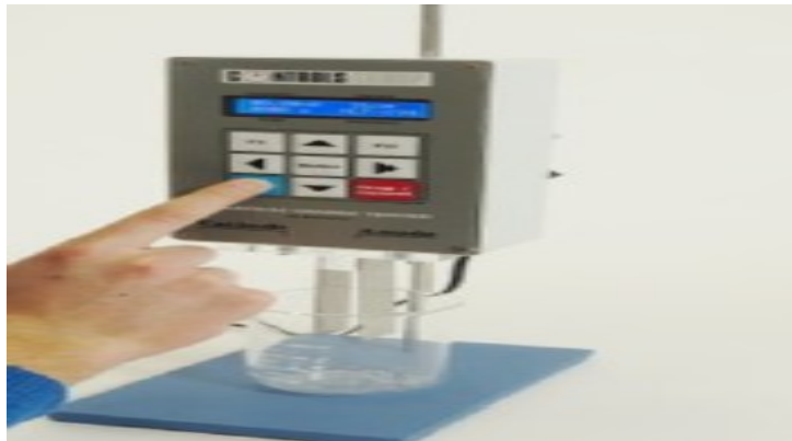
Figura 35: Ensayo de carga de partícula Fuente: Curso construcción de carreteras sostenibles (2020)
