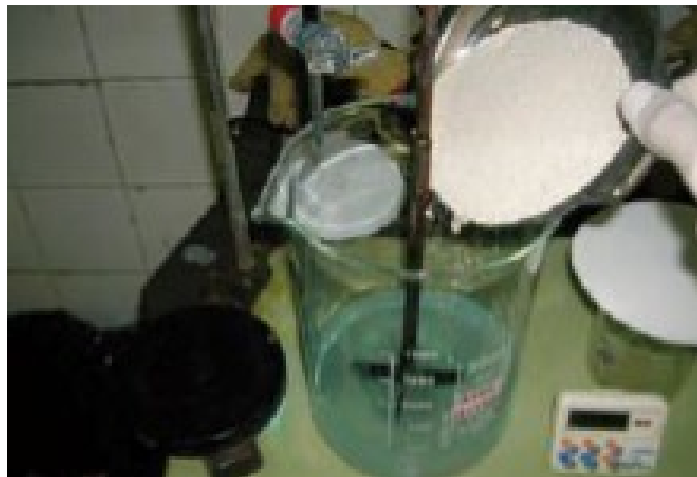
Figura 31: Ensayo de azul de metileno Fuente: Gutiérrez Abanto (2022)
