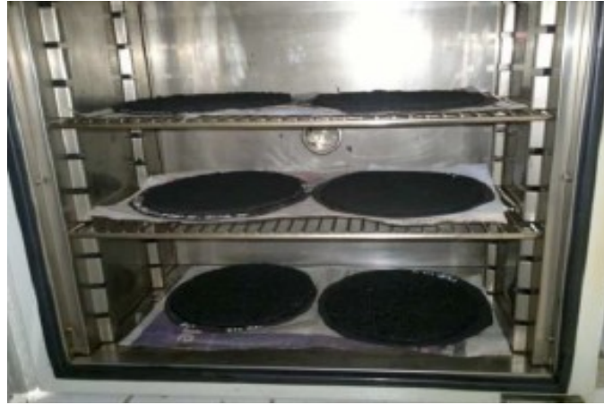
Figura 41: Muestras para el ensayo de WTAT Fuente: Quispe Espinoza (2021)
