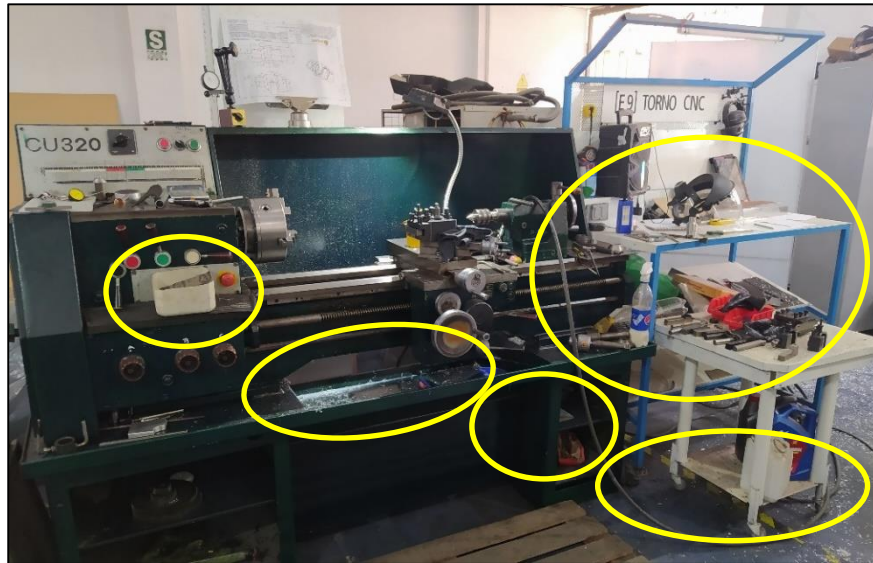
Figura N 56: Torno sucio con un contenedor con líquido, sucio y con restos de viruta. Mesa de trabajo próxima, hacinada con papeles, careta facial contenedores plásticos no rotulados y sin tapa. Piso sucio, con cableado mal ubicado. Ausencia de línea de seguridad alrededor del torno. Fuente: Elaboración propia.
