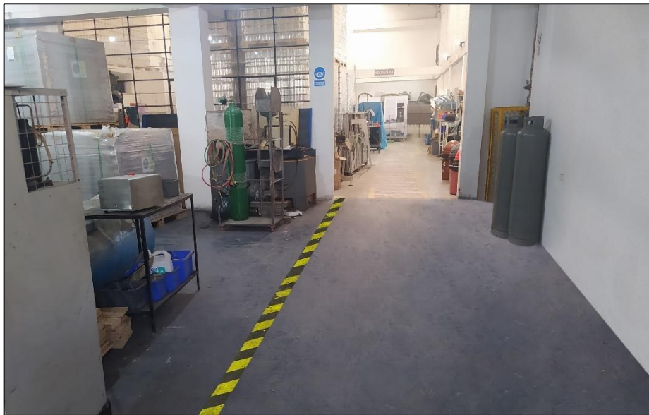
Figura N 65: Zona de conexión entre mecanizado y taller de metalmecánica despejada, se retiraron los pallets y tablonces de madera. Se instaló línea de seguridad en el piso. Fuente: Elaboración propia.
