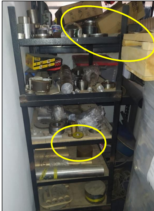
Figura N 58: Modulo de metal multinivel usado como almacén temporal de materia prima, con cajas de cartón vacías, el módulo está ubicado al costado de unos pallets con material empacado. Ausencia de rotulado e identificación de la materia prima (Cilindros y barras de acero y aluminio). Fuente: Elaboración propia.
