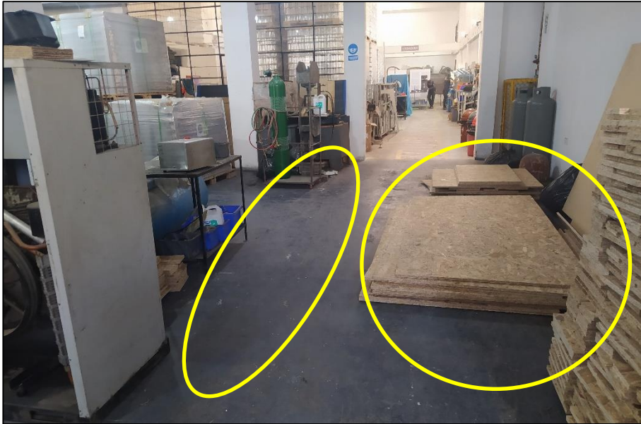
Figura N 64: Zona de conexión entre mecanizado y taller de metalmecánica bloqueada de manera permanente con pallets y tablonces de madera. Ausencia de línea de seguridad en el piso. Fuente: Elaboración propia.
