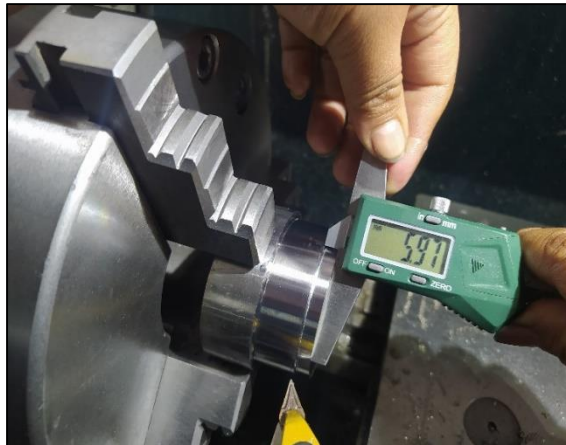
Figura N 79: Verificación de medidas externas Fuente: Asper Coating
