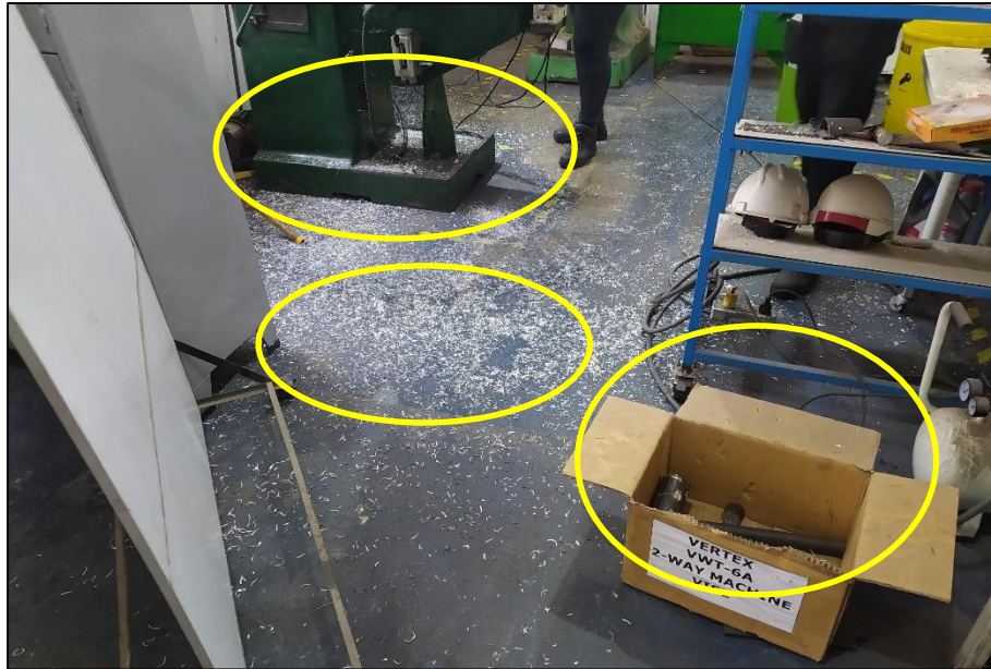
Figura N 62: Zona de la fresadora con el piso sucio, presencia de viruta. Mesa de trabajo próxima al torno (espaldar) con caja que obstaculiza el tránsito. Ausencia de líneas de seguridad en los equipos.
