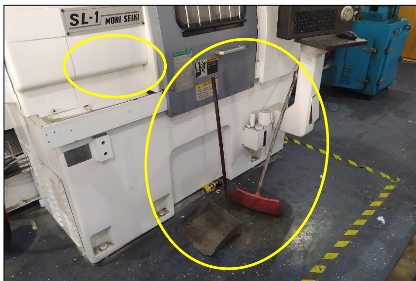
Figura N 60: Torno CNC con piso sucio y material de limpieza ubicado de la forma observada por varios días. Equipo sin identificación. Fuente: Elaboración propia.
