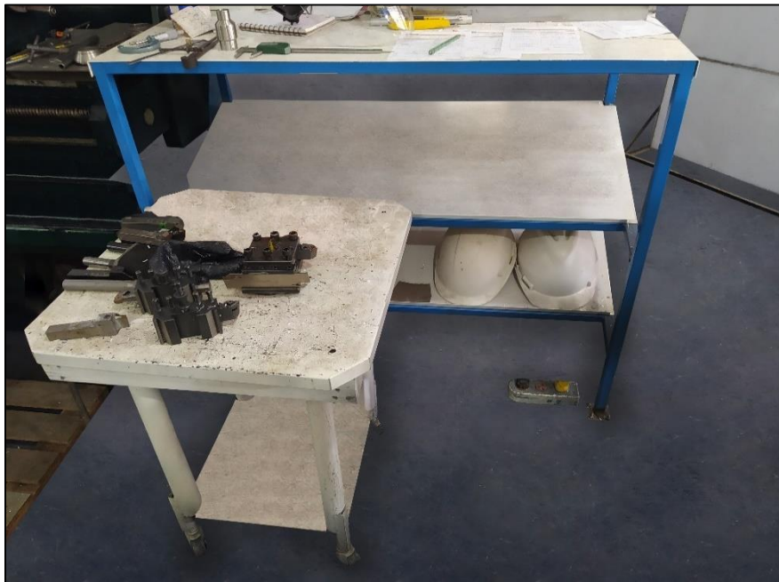
Figura N 53: Mesa de trabajo con piezas mecanizadas mejor ubicadas. Los contenedores improvisados, fueron retirados, cajas de cartón retiradas, el cableado fue reacomodado. Mesas despejadas con mayor orden y limpieza. Fuente: Elaboración propia.
