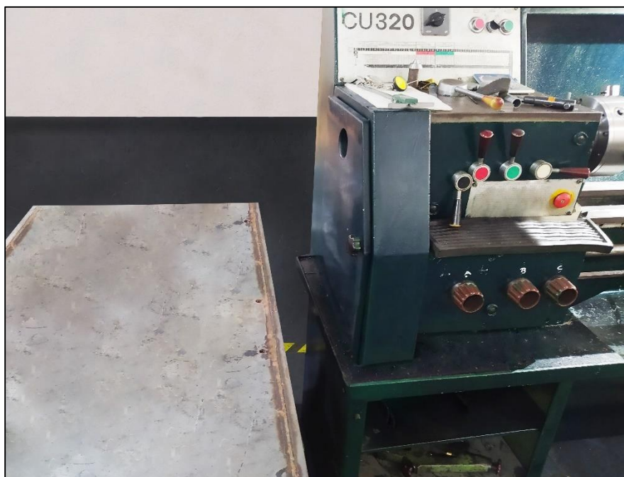
Figura N 55: Mesa de trabajo próxima al torno despejada. Contenedores de bebidas, latas, plásticos y material de desecho en la mesa de trabajo fueron retirados. Los tablones en el piso frente a la mesa de trabajo fueron reubicados. El contenedor con líquido y herramientas de ajuste en el torno fueron reubicados. Fuente: Elaboración propia.
