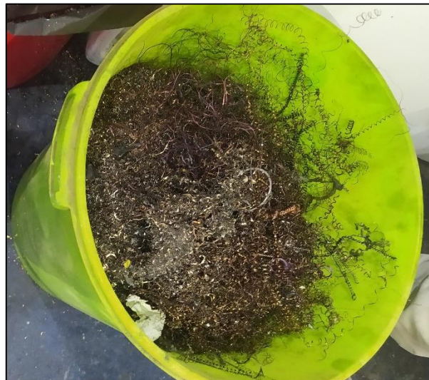
Figura N 8: Contenedor con merma de materia prima (acero) Fuente: Propia (Fotografía tomada en una visita a planta)
