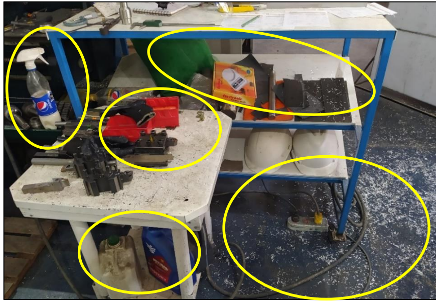
Figura N 52: Mesa de trabajo con piezas mecanizadas en desorden, contenedores improvisados, cajas de cartón, piso sucio y cableado eléctrico dispuesto de manera inadecuada. Desorden Generalizado Fuente: Elaboración propia.
