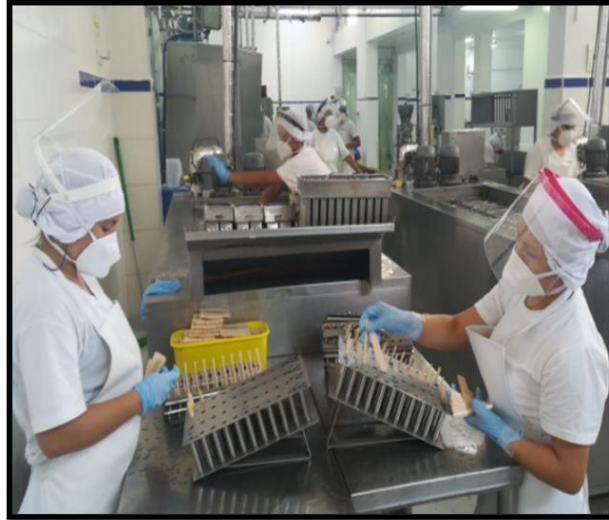
Figura 18: Colocado de palitos en tapas de moldes
