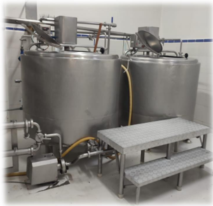
Figura 27: Tanques de pasteurizado
