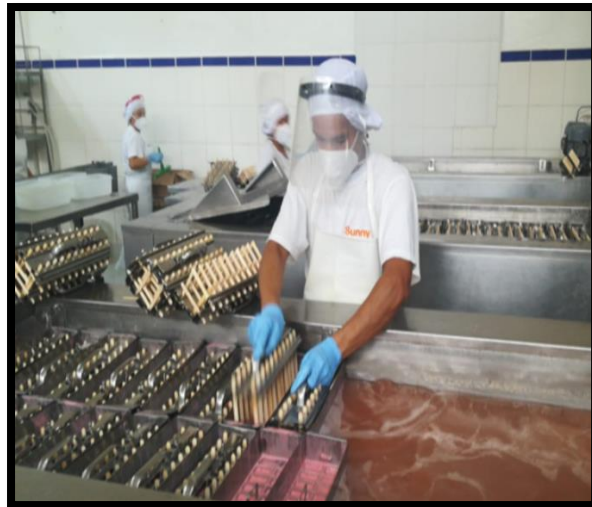
Figura 19: Colocado tapas de moldes y congelado
