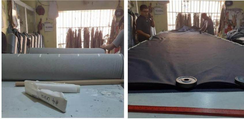
Figura 16: Desenrollado y tendido de tela
