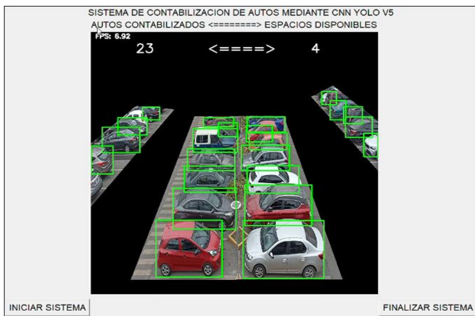
Figura N 62: Cantidad máxima de autos contados por YOLO v5 con umbral de 0.55 y con 27 espacios Fuente: Elaboración propia
