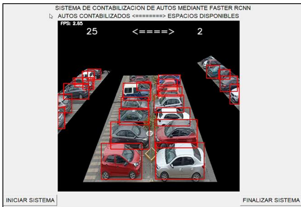
Figura N 66: Cantidad máxima de autos contados por Faster RCNN con umbral de 0.55 y con 27 espacios
