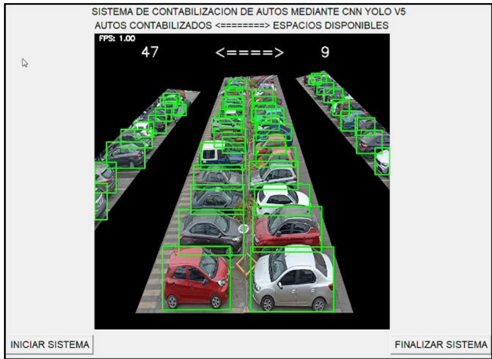
Figura N 41: Cantidad máxima de autos contados por YOLO v5 con umbral de 0.35 y con 56 espacios Fuente: Elaboración propia
