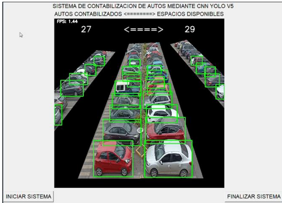
Figura N 43: Cantidad máxima de autos contados por YOLO v5 con umbral de 0.55 y con 56 espacios Fuente: Elaboración propia
