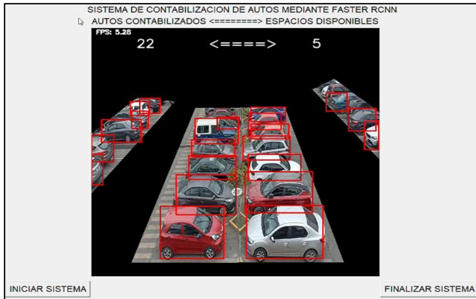
Figura N 65: Cantidad mínima de autos contados por Faster RCNN con umbral de 0.55 y con 27 espacios
