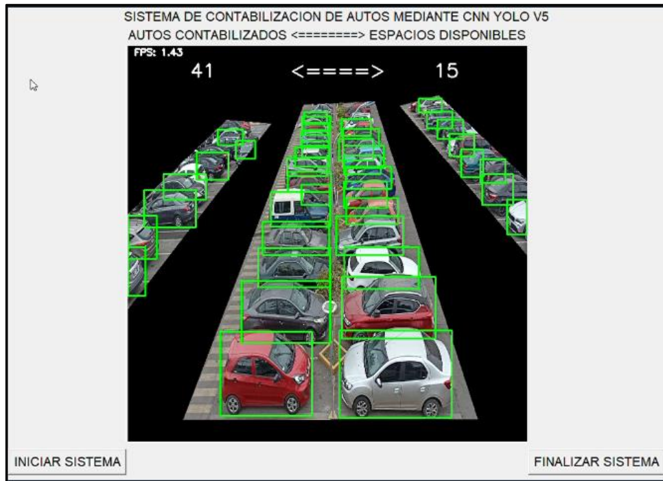
Figura N 40: Cantidad mínima de autos contados por YOLO v5 con umbral de 0.35 y con 56 espacios Fuente: Elaboración propia
