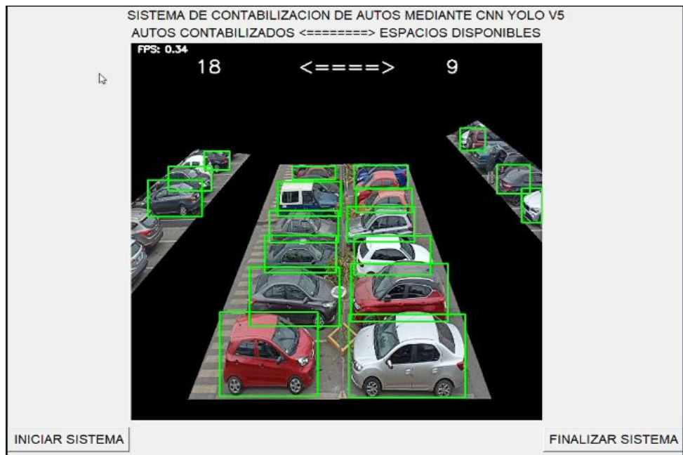
Figura N 61: Cantidad mínima de autos contados por YOLO v5 con umbral de 0.55 y con 27 espacios Fuente: Elaboración propia
