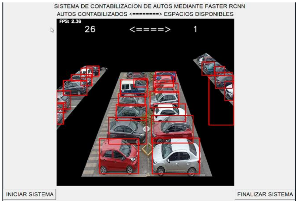
Figura N 63: Cantidad mínima de autos contados por Faster RCNN con umbral de 0.35 y con 27 espacios Fuente: Elaboración propia
