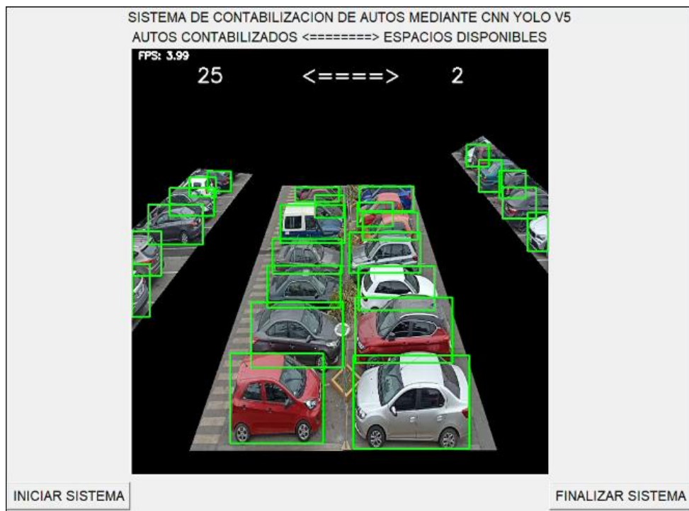
Figura N 60: Cantidad máxima de autos contados por YOLO v5 con umbral de 0.35 y con 27 espacios Fuente: Elaboración propia
