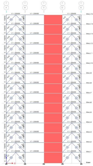
Figura 41: Ubicación de disipadores en la elevación 7 ( X-X)
