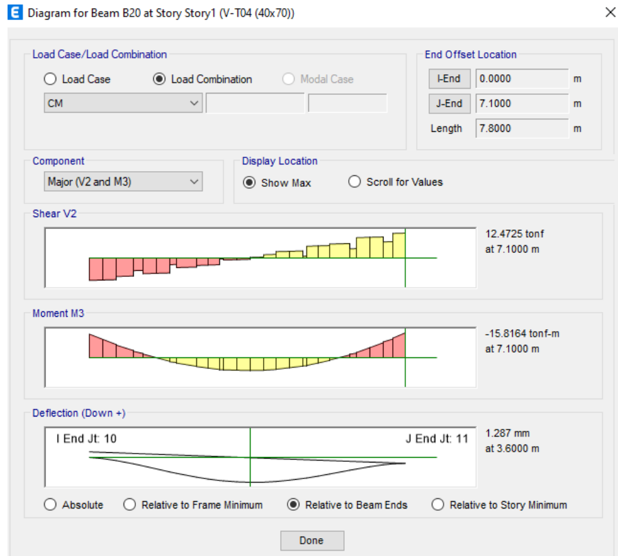
Figura N°46: Cortante máximo por carga muerta en VT-04 del piso 6 Fuente: Elaboración propia
