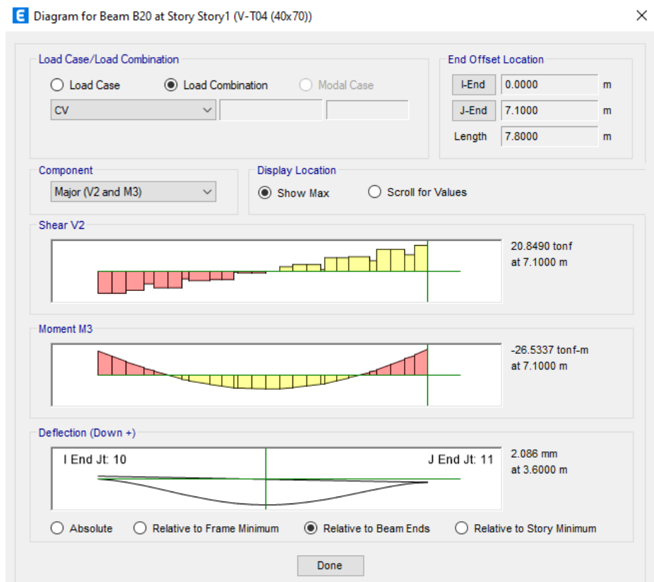
Figura N°47: Cortante máximo por carga viva en VT-04 del piso 6 Fuente: Elaboración propia
