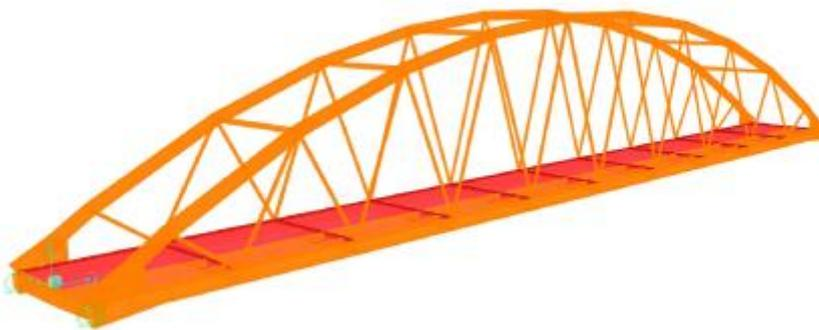
Figura 49: Modelamiento del tramo central – arco metálico reticulado.
