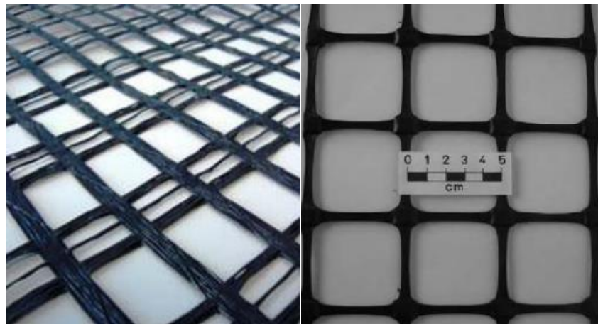
Figura 21: Geomalla biaxial extruida y tejida.
