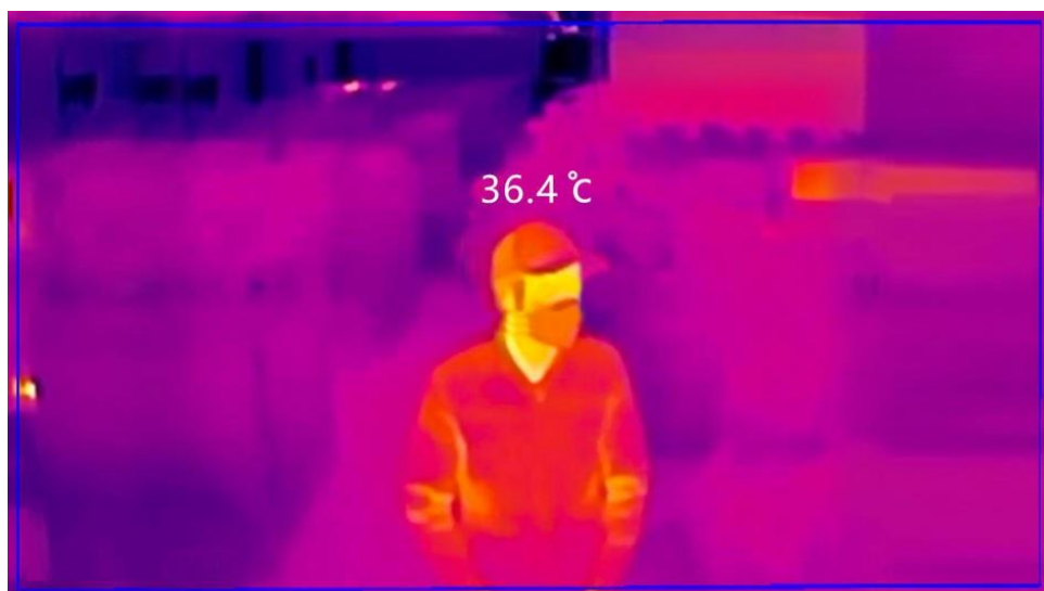
Figura 64: Detección de temperatura corporal por medio de visión artificial.
