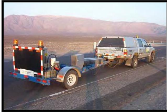
Figura N°9. Deflectómetro de impacto
