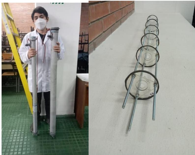
Figura 49: Floculador placa orificio. Tubo floculador (Izq.) y sistema placa orificio (Der.)
