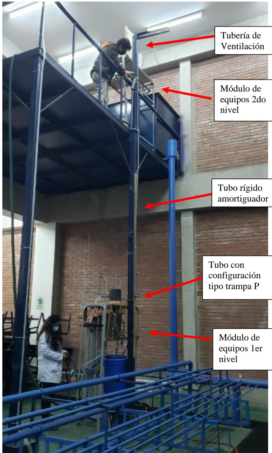
*Figura 58:* Floculador piloto trabajando en el 1er y 2do nivel del laboratorio de hidráulica.
