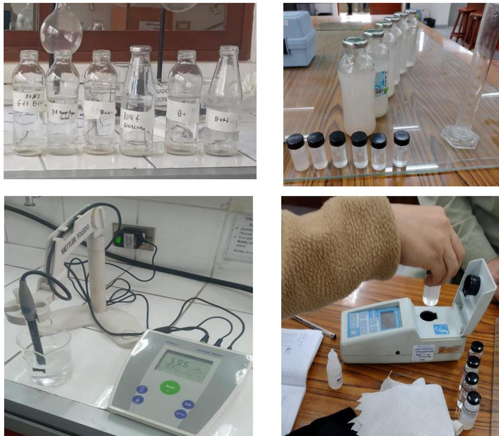
Figura 54: Frascos para almacenamiento de muestras (Sup. Izq), frascos con muestras de agua (Sup. Der), Potenciómetro o Ph metro (Inf. Izq), Medición de turbiedad (Inf. Der).
