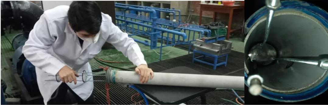
*Figura 62:* Inserción de la armadura de placa orificio en el interior del tubo floculador (Izq.)
