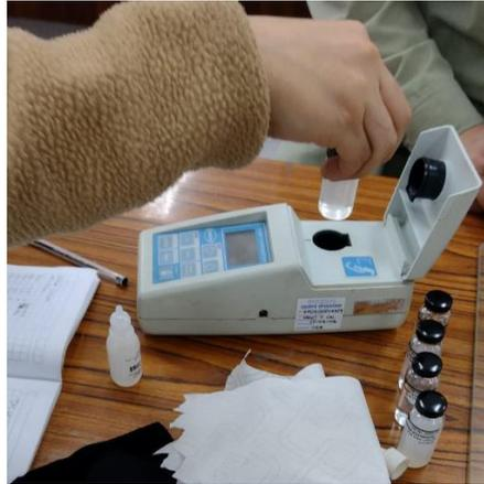
*Figura 51:* Colocación de la muestra en turbidímetro para toma de lectura de turbiedad.
