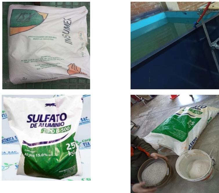
Figura 50: Arcilla caolinita (Sup. Izq.), Tanque de agua superficial sintética (Sup. Der), Coagulante en presentación granular (Inf. Izq.) y Coagulante tamizado (Inf. Der)
