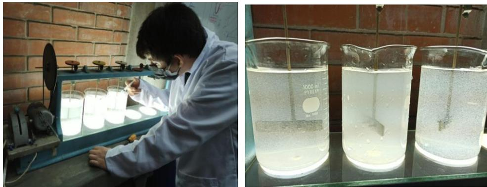
*Figura 52:* Prueba de jarras - Inoculación de coagulante (Izq.) y Floculación (Der.)
