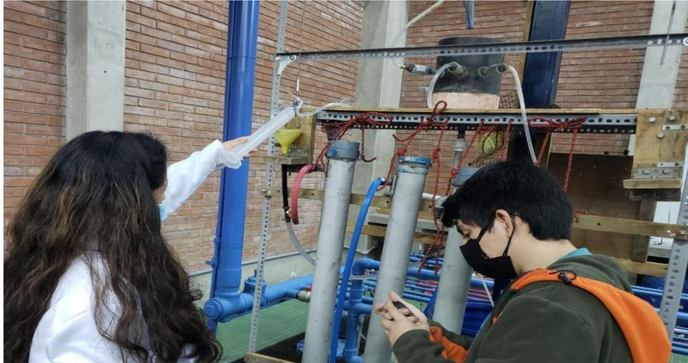
Figura 46: Aforo por método volumétrico.
