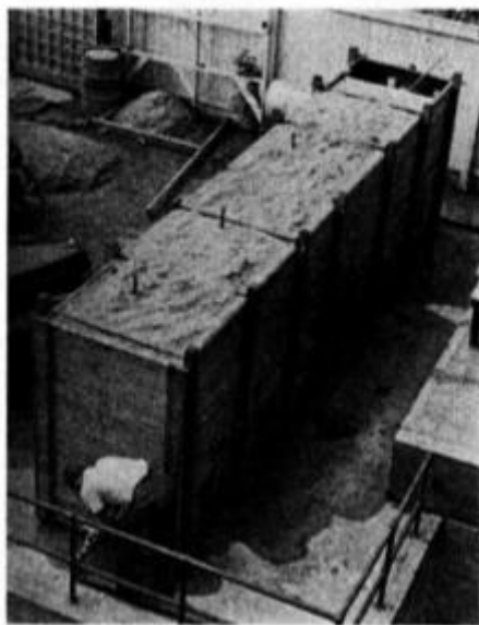
Figura N° 4: Tanque usado en el modelo de drenaje
