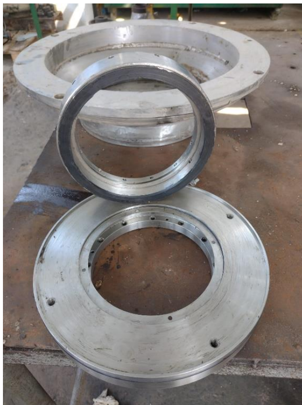
Figura 24: Sello mecánico del SP1200 Fuente: Área de mantenimiento – Papelera del Sur S.A. Elaboración: Propia
