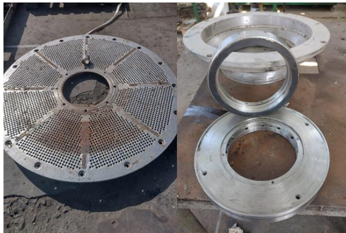
Figura 3: Desgaste prematuro de la escriba o tamiz / Falla del sello mecánico Fuente: Área de mantenimiento – Papelera del Sur S.A. Elaboración: Propia
