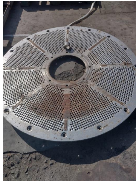
Figura 21: Tamiz del Pulper Voith Fuente: Área de mantenimiento Elaboración: Propia
