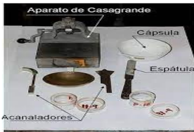
Figura 24. Materiales para el ensayo de límite plástico y límite líquido Fuente: Portal Caminos UPM.
