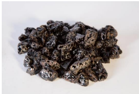
Figura 4. Adherencia en la mezcla asfáltica
