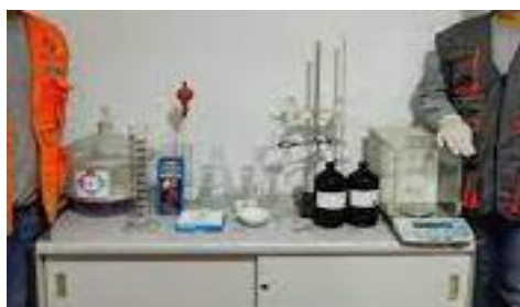
Figura 25. Sales solubles en agregados finos Fuente: JC Geotecnia laboratorio SAC.
