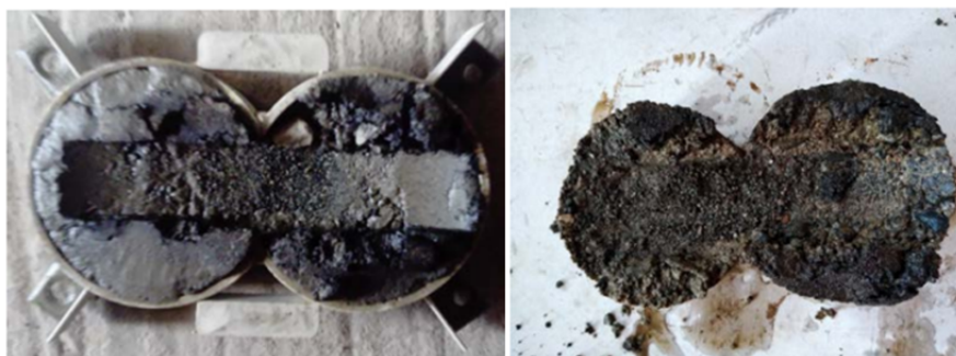
Figura N° 31: Briquetas sometidas a ensayo de la Rueda de Hamburgo Fuente: Aguilar, D. 2021
