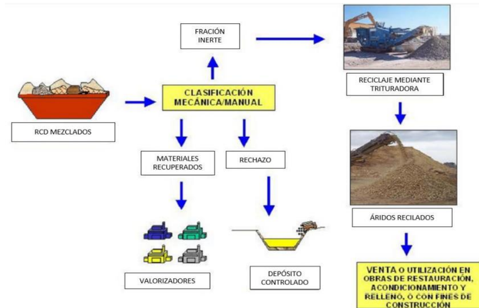
Figura 24: Procesos del tratamiento de los RCD en una planta de valorización
