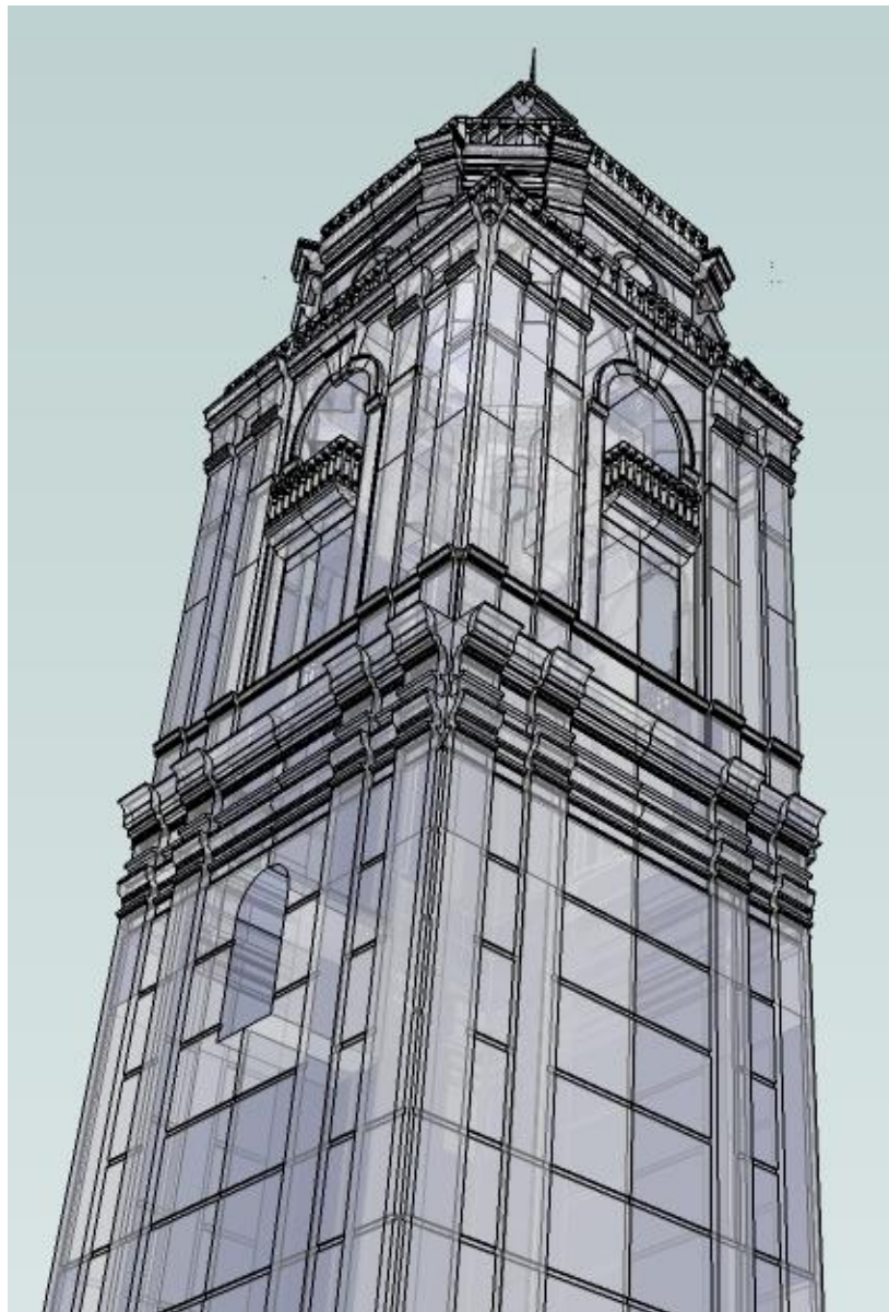
Fig. Nro. 11.- Levantamiento de la Torre, imagen tridimensional a partir de planos y datos de campo.
