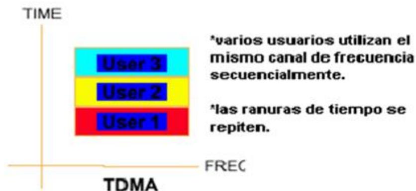
Figura 2 TÉCNICA DE MULTIACCESO PARA ENLACE DE RADIO
