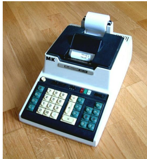
Un ejemplo del microprocesador 4004 y el equipo que lo usó: la Busicom 141 PF
