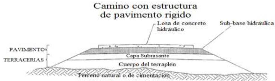
Figura 2.1 Componentes Estructurales de un Pavimento Rígido
