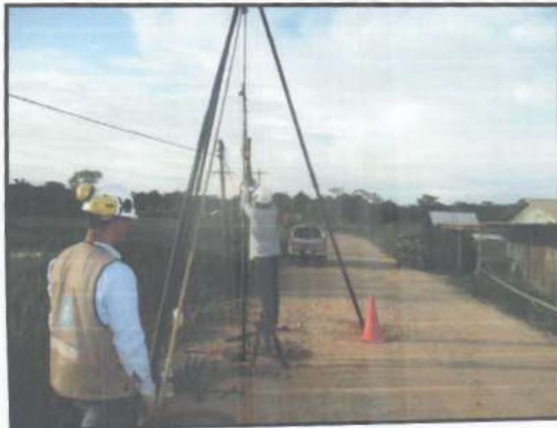
FOTO N° 26: SE OBSERVA LA VISTA PANORAMICA DEL ENSAYO DE PENETRACION (SPT)
