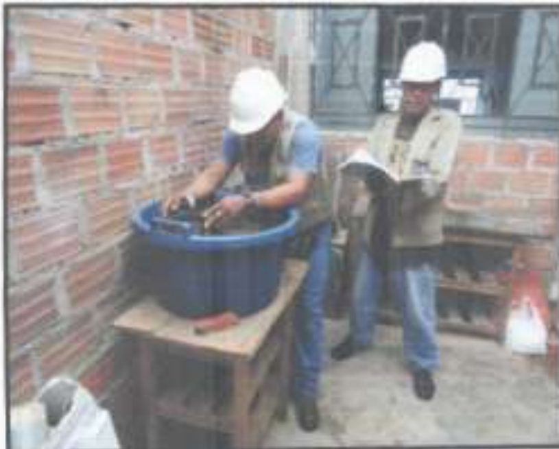
FOTO N°26: SE OBSERVA AL PERSONAL TECNICO MIXTIENDO LA EXPANSION DE LA MUESTRA ENSAYADA (CMR)
