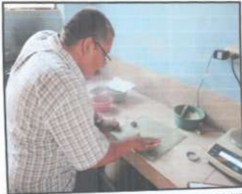
FOTO N°24: SE OBSERVA AL PERSONAL TECNICO REALIZANDO ENSAYO DE LIMITE LIQUIDO Y PLASTICO.
