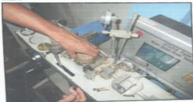
FOTO N°22: SE OBSERVA LA VISTA PANORAMICA DEL ENSAYO DE CORTE DIRECTO
